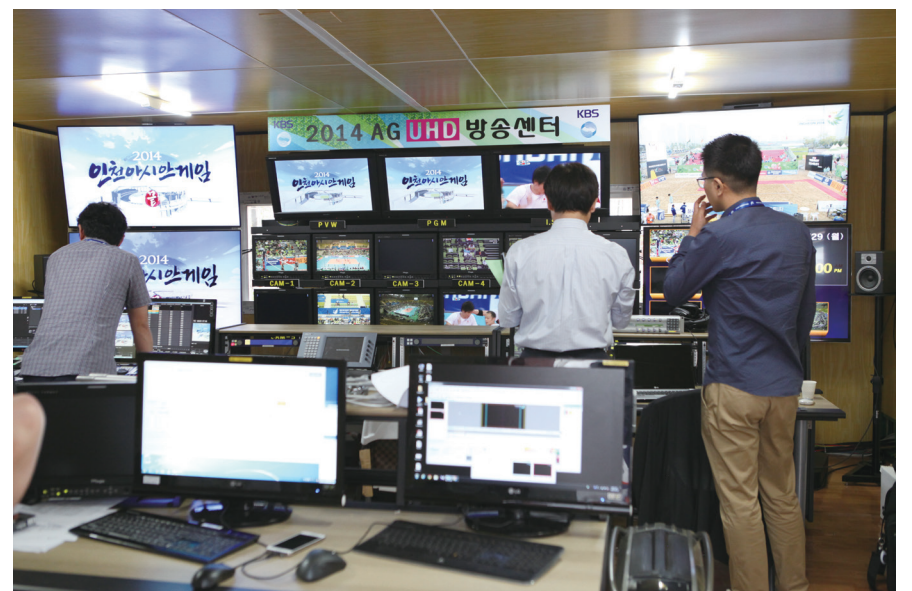
초고화질(UHD) 방송 KBS, MBC, SBS 등 지상파방송 3사는 인천아시안게임 중 일부를 초고화질(UHD) 방송으로 내보냈다. KBS의 경우 인천 현지의 UHD 방송센터에서 제작된 신호가 KBS 본사를 거쳐 남산과 관악산 송신소로 전송되고, 각 송신소에서는 SFN 기술을 적용해 채널 54번(70MHz~76MHz)을 통해 DVB-T2 방식으로 UHD 신호를 송신했다. 이에 따라 수도권에 UHD TV 보유 가구에서는 UHD 영상으로 아시안게임을 시청할 수 있었다.
