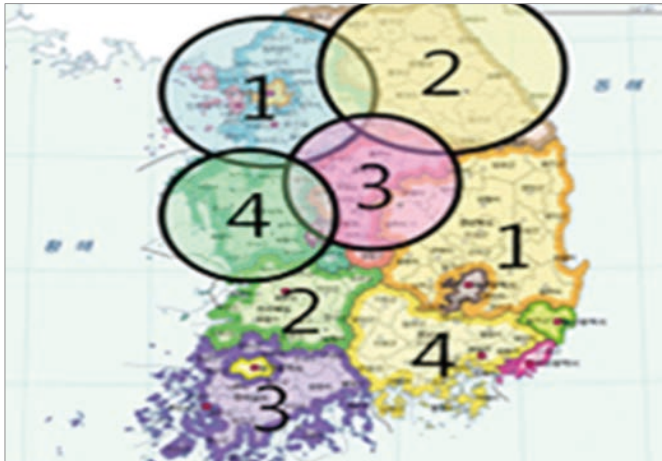
[그림1] 4개의 주파수에 의한 전국망 SFN 구성도
